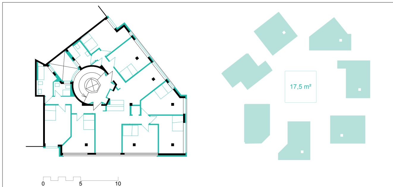
Abb. 140: Regelgeschoss mit der Aufteilung des offenen Grundrisses in Groß-WGs: es ergeben sich sieben Zimmer mit je 17,5 m 2 Fläche (grün). © Meides & Schoop Architekten, Bearbeitung subsolar*
