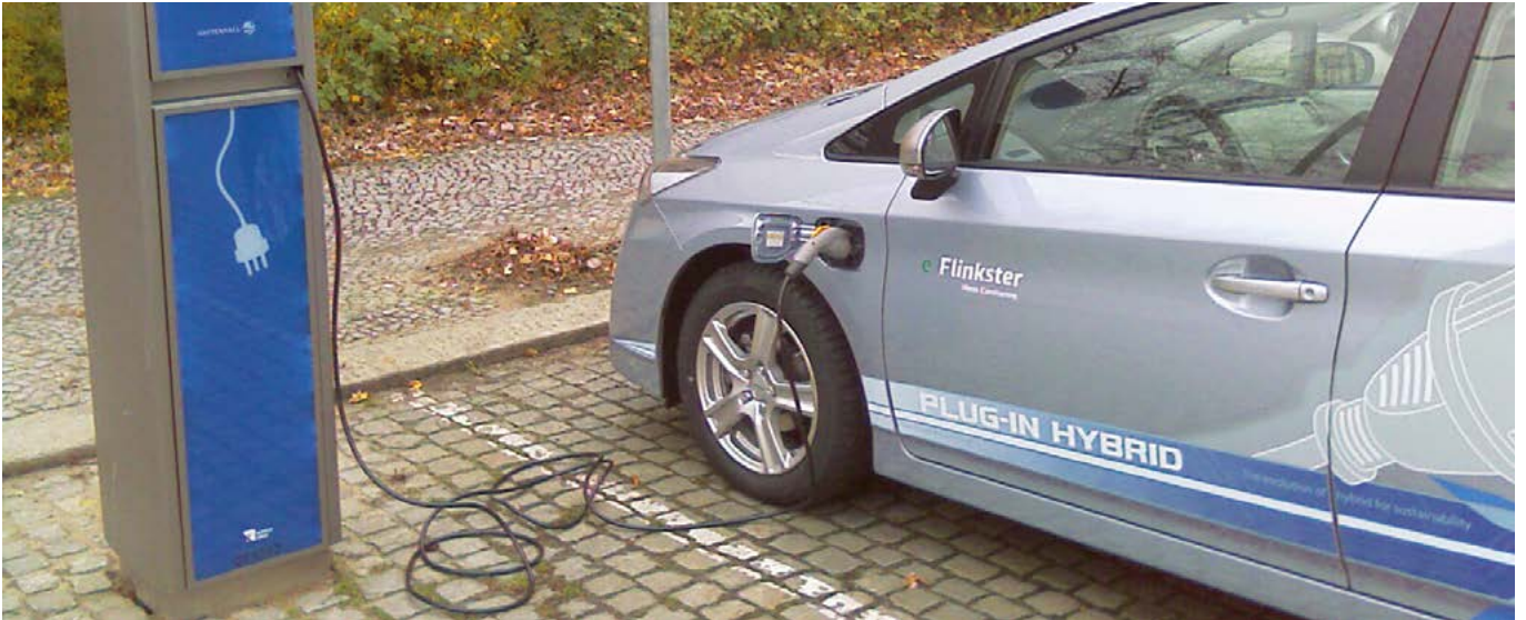
Abb. 4: Flächenbedarf für Ladesäule reduziert Parkplätze.
