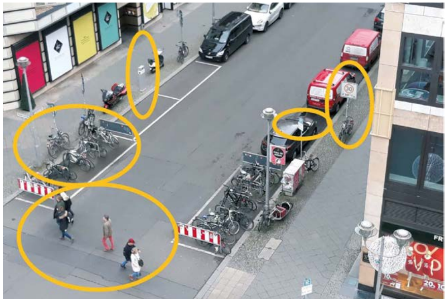
Abb. 4: Kombination „einfacher“ Maßnahmen im Straßenraum: Fahrradbügel in der Fahrbahn; Sicherung der Fußgängerquerung; Tempo-30-Zone; E-Ladestation; Parkraumbewirtschaftung (Quelle: Siegfried Dittrich)
