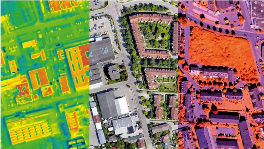
Abb. 1: Während eines Einzelflugs parallel erhobene Thermal-, RGB- und Multispektralluftbilddaten (3D RealityMaps 2022)
