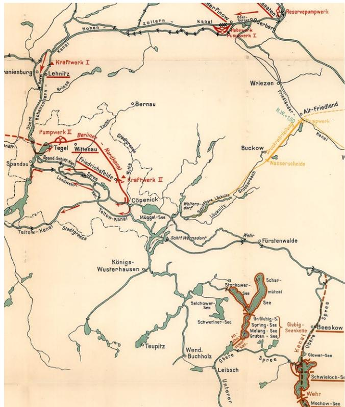
Abb. 3: Mögliche Wassertransferleitungen und Staubecken für die Berliner Wasserversorgung, 1928 (Quelle: Hahn 1928, Anhang 2)
