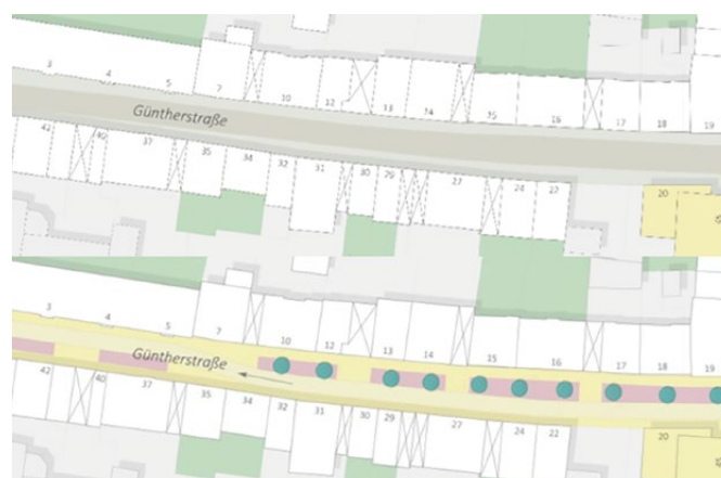
Abb. 4: Empfehlungen zur Umgestaltung des Straßenraums in Folge der geplanten Wärmeplanung, oben Bestand, unten Empfehlung (Grafik bgmr/Planersocietät)
